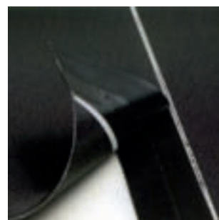
Endlosverbindungsarten, 3-lagiger Gurt, Überlappung bei 70°-Winkel
