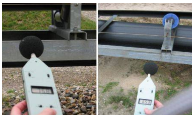
Lärmpegelvergleich gegenüber stählernen Tragrollen (75,8 dB Stahlrolle; 65,3 dB Kunststoffrolle)
